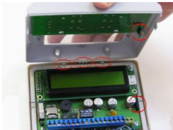
Рис. 4 Снятие и установка крышки ПУО
