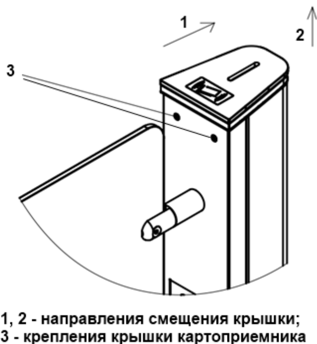
Рисунок 3 – Снятие верхней крышки картоприемника
