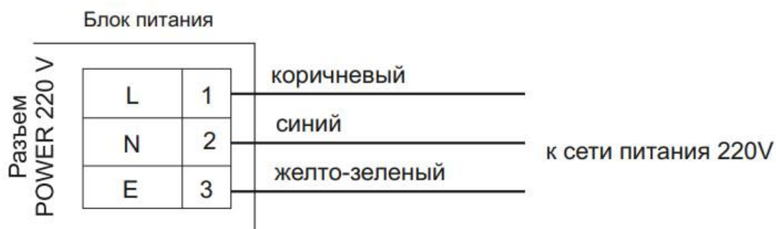
Рисунок 25. Схема подключения блока питания
