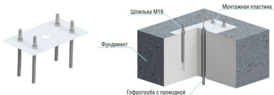
Рисунок 19. Устройство фундамента с монтажным комплектом.
