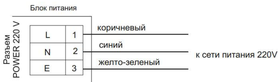
Рисунок 26. Схема подключения блока питания
