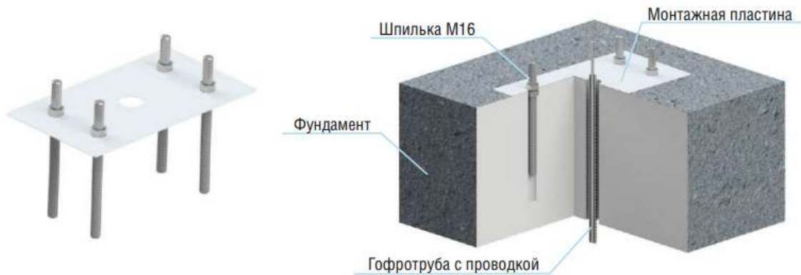
Рисунок 20. Устройство фундамента с монтажным комплектом.
