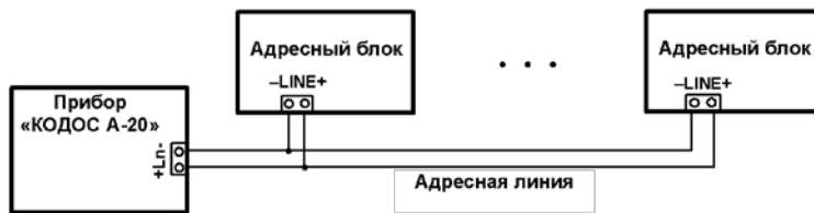
Рисунок 1 – Подключение адресных блоков системы ОПС к прибору А-20
