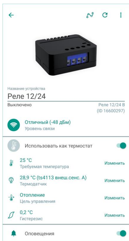
Рисунок 11.2 — Экран настройки радиоустройства в режиме термостата
