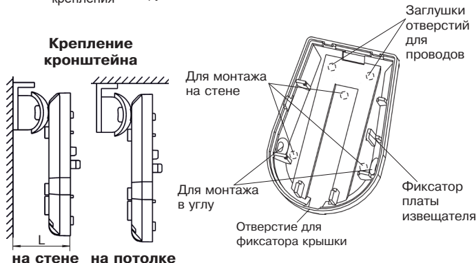
Рисунок 2 – Основание извещателя и кронштейн
