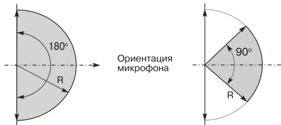
Рисунок 2 – Диаграмма зоны обнаружения АК канала
