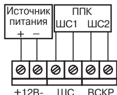
Рисунок 2 – Схема подключения извещателя с отдельными шлейфами сигнализации и вскрытия корпуса
