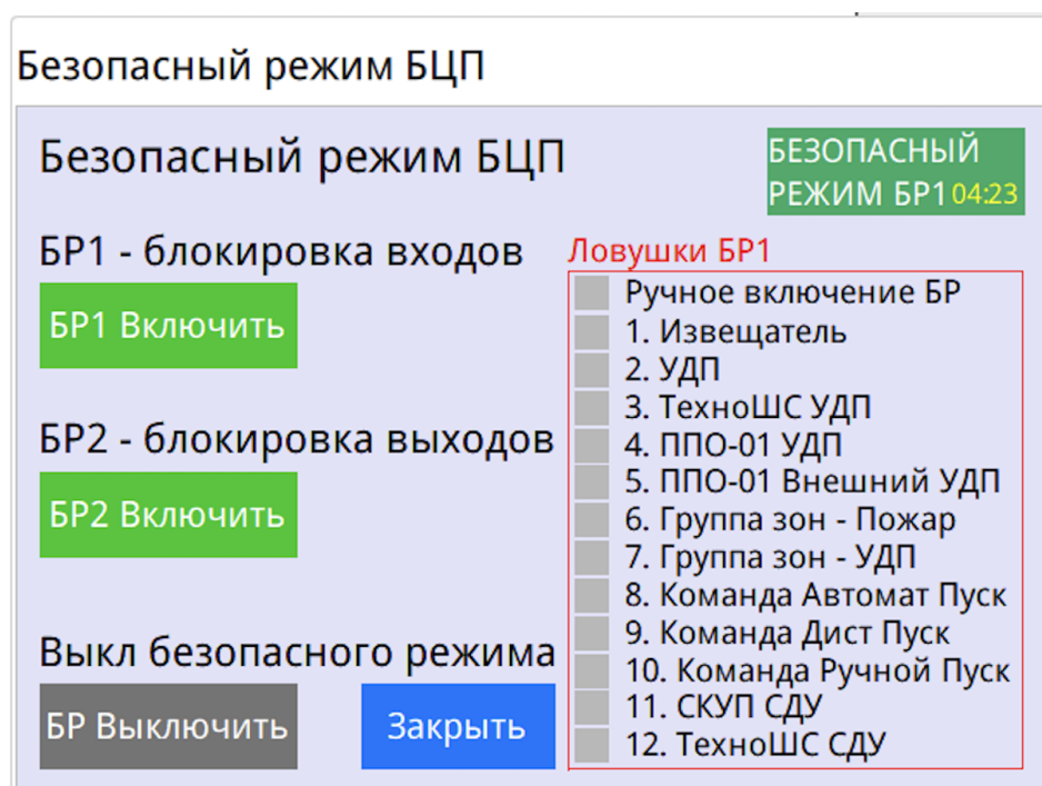
Рис. 3 Панель управления БР
