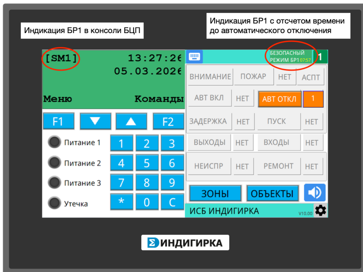
Рис.1 Индикация режима БР1 на ПУ-04
