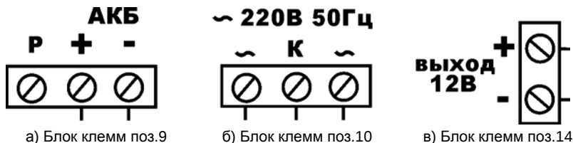
Рисунок 25 – Маркировка блоков клемм ББП
