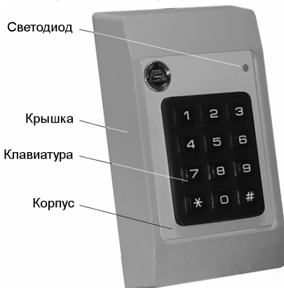
Рисунок 37 – Внешний вид считывателей «КОДОС RD-41» («КОДОС RD-101»)
