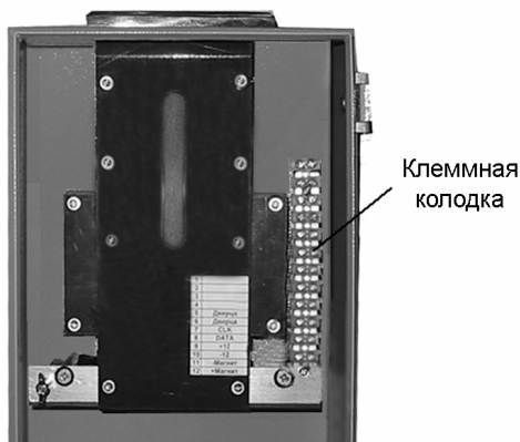
Рисунок 47 – Вид корпуса со снятой декоративной панелью
