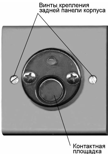
а) Общий вид считывателя
