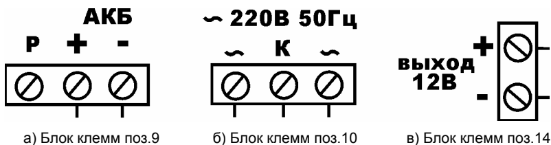
Рисунок 52 – Маркировка блоков клемм ББП
