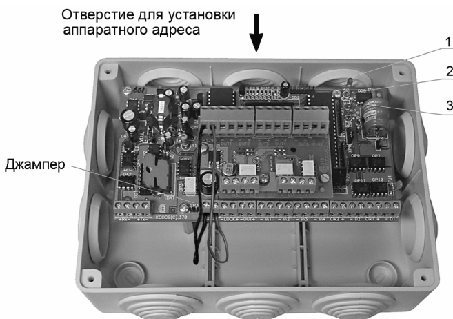
Рисунок 4 – Общий вид контроллеров «КОДОС ЕС-601/602» и «КОДОС ЕС-304»
