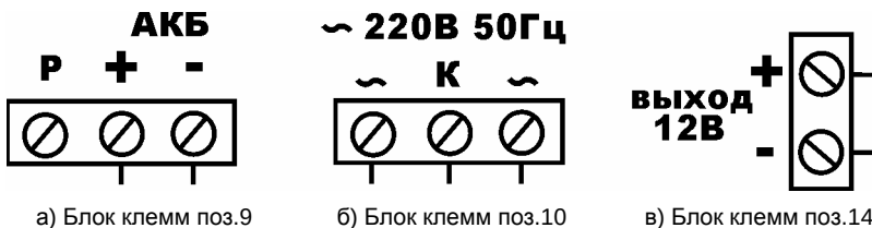
Рисунок 44 – Маркировка блоков клемм ББП
