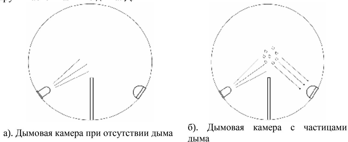
Рис. 2. Принцип функционирования оптического ПИ
