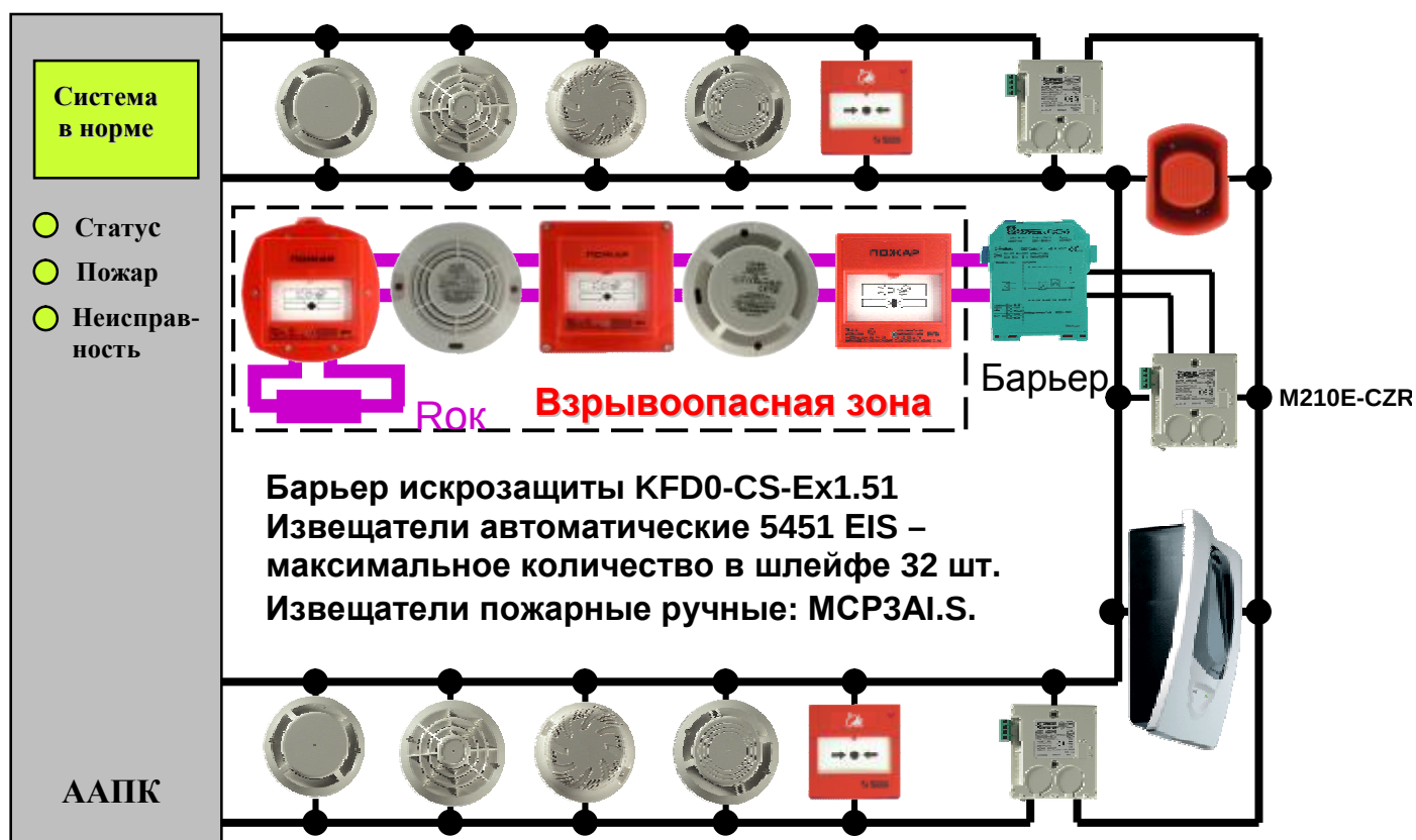
Рис.35. Схема подключения искробезопасных неадресных извещателей в адресно-аналоговый шлейф
