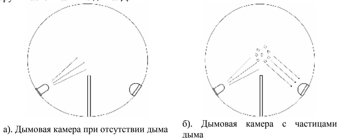
Рис. 2. Принцип функционирования оптического ПИ
