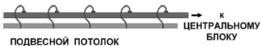
Рис. 29. Установка воздухозаборной трубы за подвесным потолком
