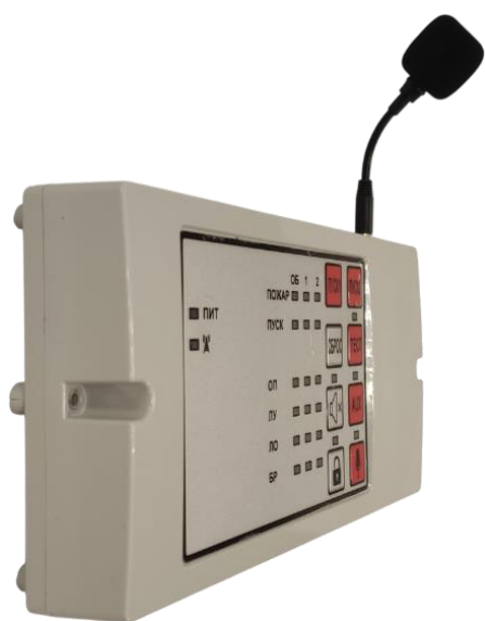
Установка микрофона для настенного крепления прибора
