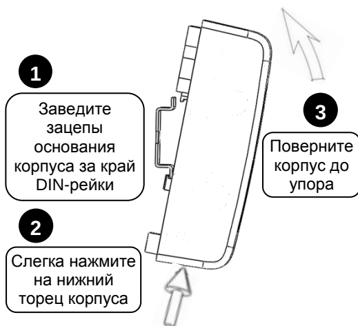
Рисунок 3. Крепление блока на DIN-рейку
