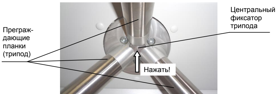
Рис.4 Место расположения центрального фиксатора трипода
