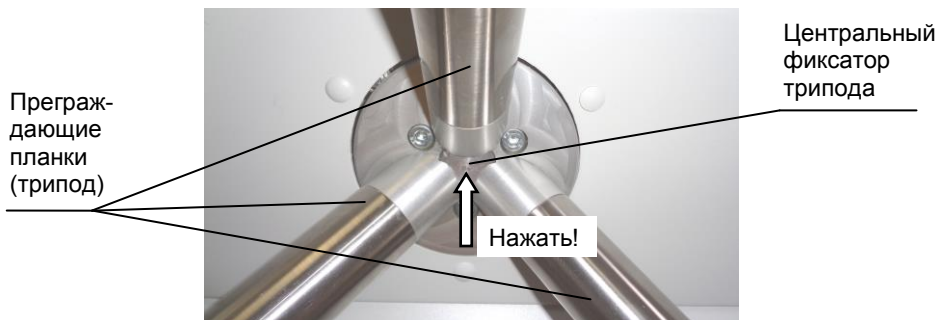
Рис.4 Место расположения центрального фиксатора трипода
