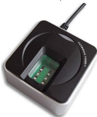
Внешний вид оптического сканера отпечатков пальцев FS81H
