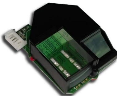
Внешний вид оптического сканера отпечатков пальцев FS81H
