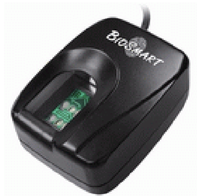
Внешний вид оптического сканера отпечатков пальцев FS-80
