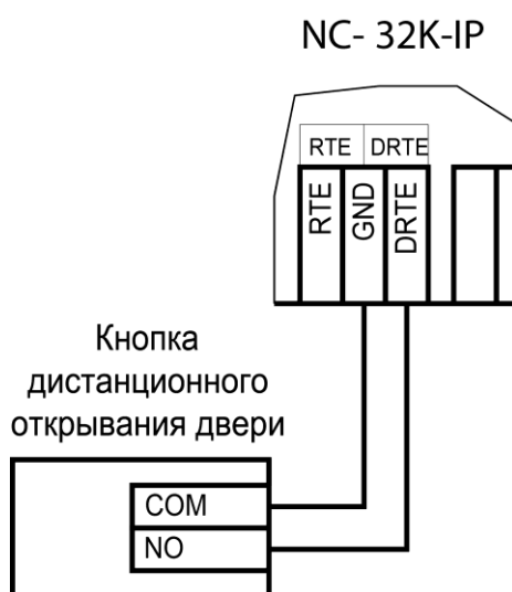
Рисунок 18. Схема подключения кнопки дистанционного открывания двери
