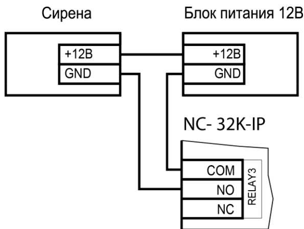
Рисунок 23. Подключение сирены к дополнительному реле
