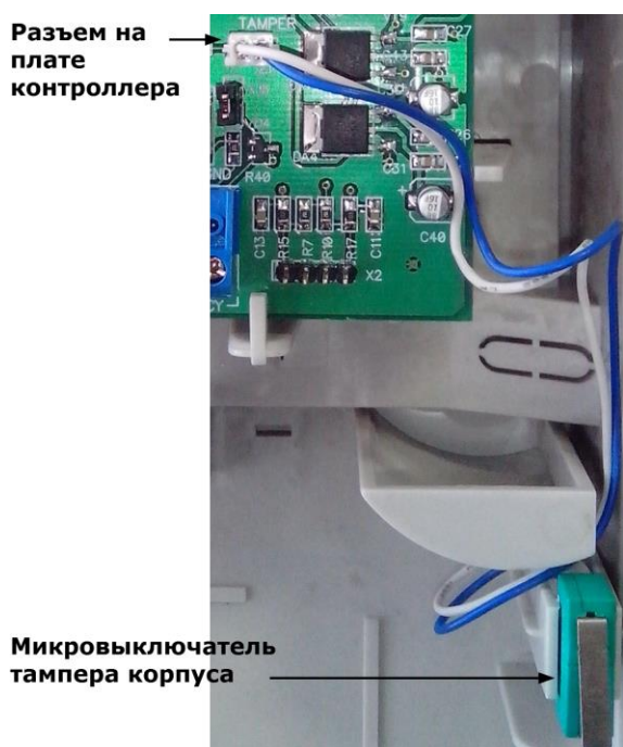
Рисунок 24. Подключение тампера корпуса
