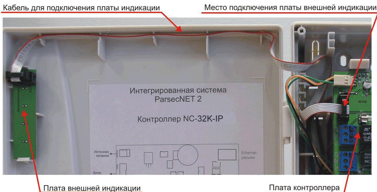
Рисунок 28. Схема подключения платы внешней индикации
