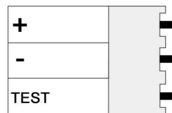
Рисунок 3. Назначение контактов разъема POWER
