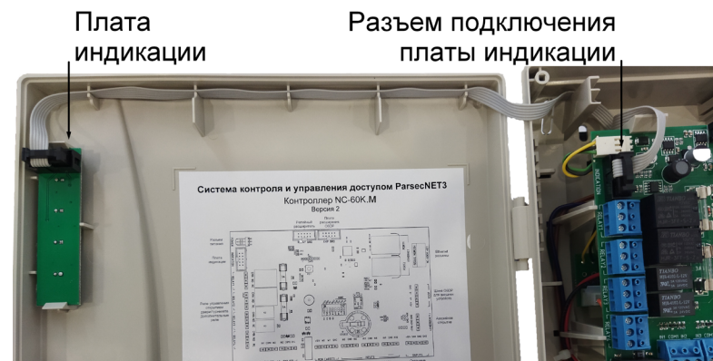
Рисунок 29. Подключение платы внешней индикации
