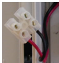
Рисунок 12. Клеммы для подключения замка к блоку питания
