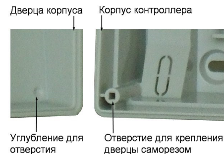
Рисунок 5. Схема «жесткого» крепления дверцы к корпусу контроллера
