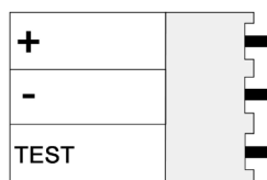
Рисунок 3. Назначение контактов разъема POWER
