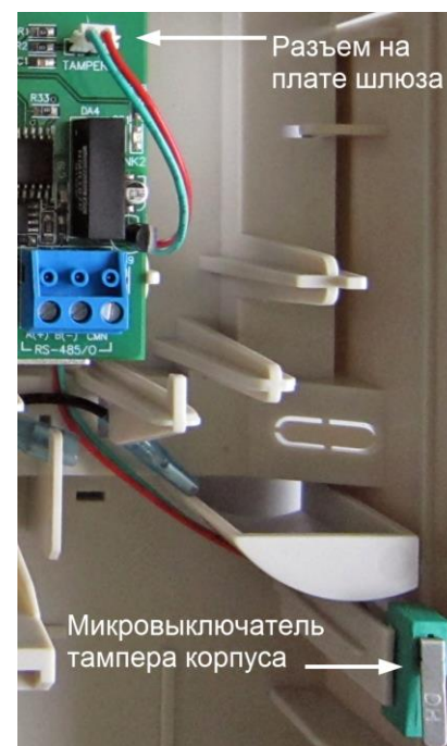
Рисунок 11. Подключение тампера корпуса
