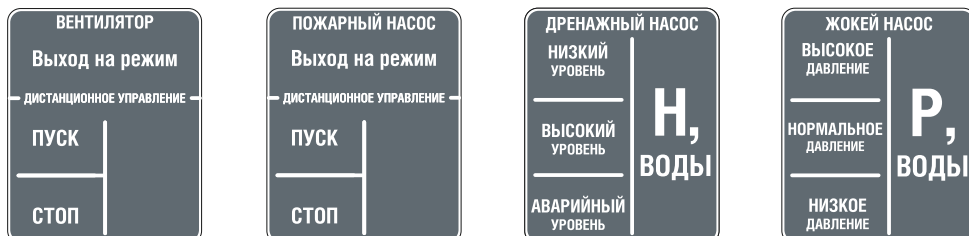
Рисунок 5 – Сменная этикетка панели управления ШУ
