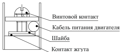
Рисунок 7 – Установка выхода на двигатель
