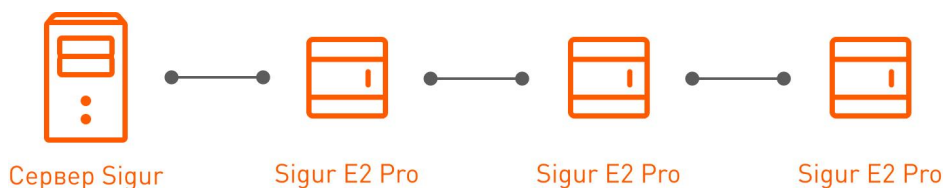
Пример подключения контроллеров E2 Pro по последовательной топологии.
