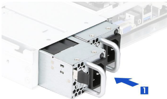
Установка блока питания.
