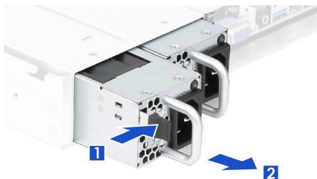
Извлечение блока питания.
