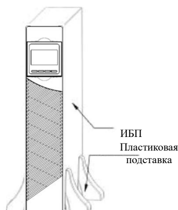
Рисунок 12. Поворот ЖК-дисплея ИБП при напольной установке.
