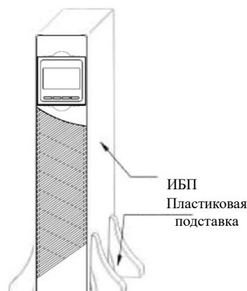
Рисунок 12. Поворот ЖК-дисплея ИБП при напольной установке.
