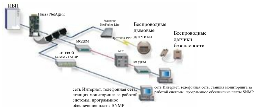
Стандартная топология сетевого управления ИБП
