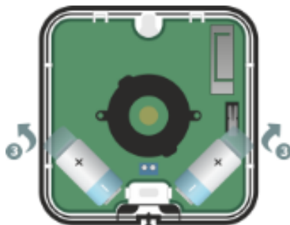
Рисунок 6.3 — Удаление защитных пленок с батарей сирены
