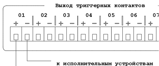
Рис. 3.5. Схема подключения внешних исполнительных устройств к LPA-PRESTA-2.
