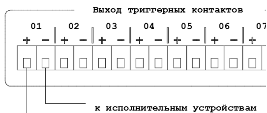
Рис. 3.5. Схема подключения внешних исполнительных устройств к LPA-PRESTA-8.
