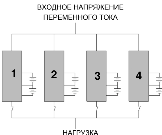
Рисунок 24 — Схема подключения изделий в систему параллельного резервирования.
