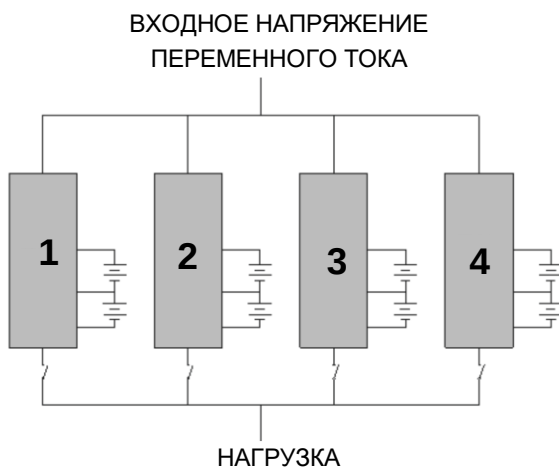
Рисунок 24 — Схема подключения изделий в систему параллельного резервирования.
