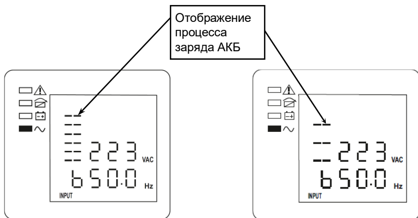
Рисунок 21 — ЖК-дисплей, форсированный (ускоренный) заряд АКБ
