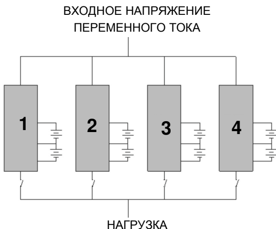
Рисунок 24 — Схема подключения изделий в систему параллельного резервирования.
