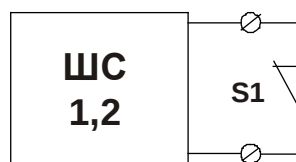
Схема 5 Подключение НЗ контактов без контроля целостности линии связи.
