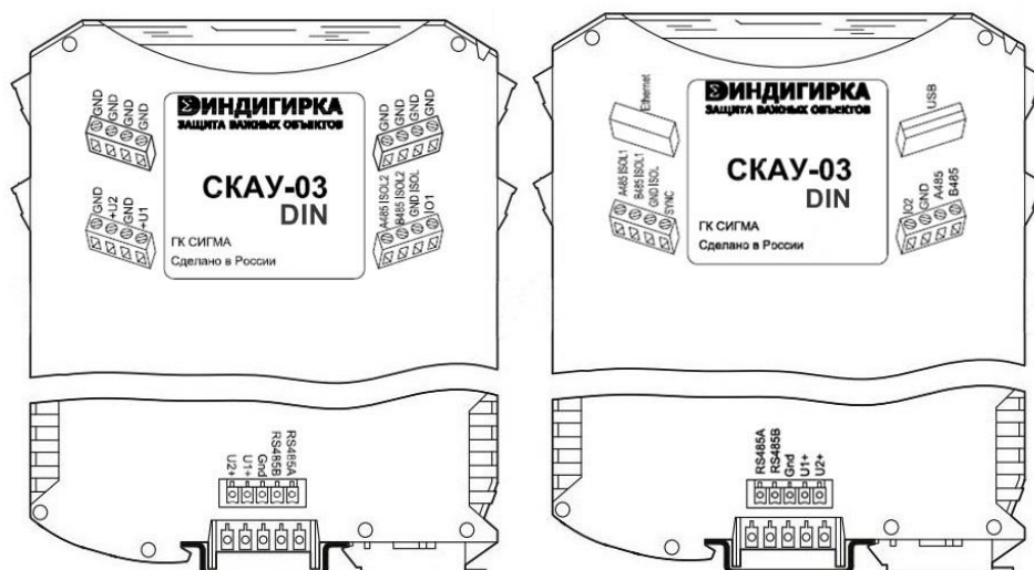
Рис. 2 Условная схема размещения клемм СКАУ-03 DIN
