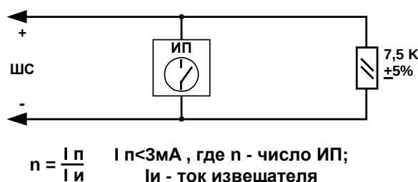
Рис. 10 Пожарный ШС с активным ИП (при срабатывании одного ИП формируется извещение «Пожар»)
