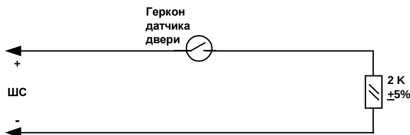
Рис. 18 ШС для контроля состояния датчика двери
