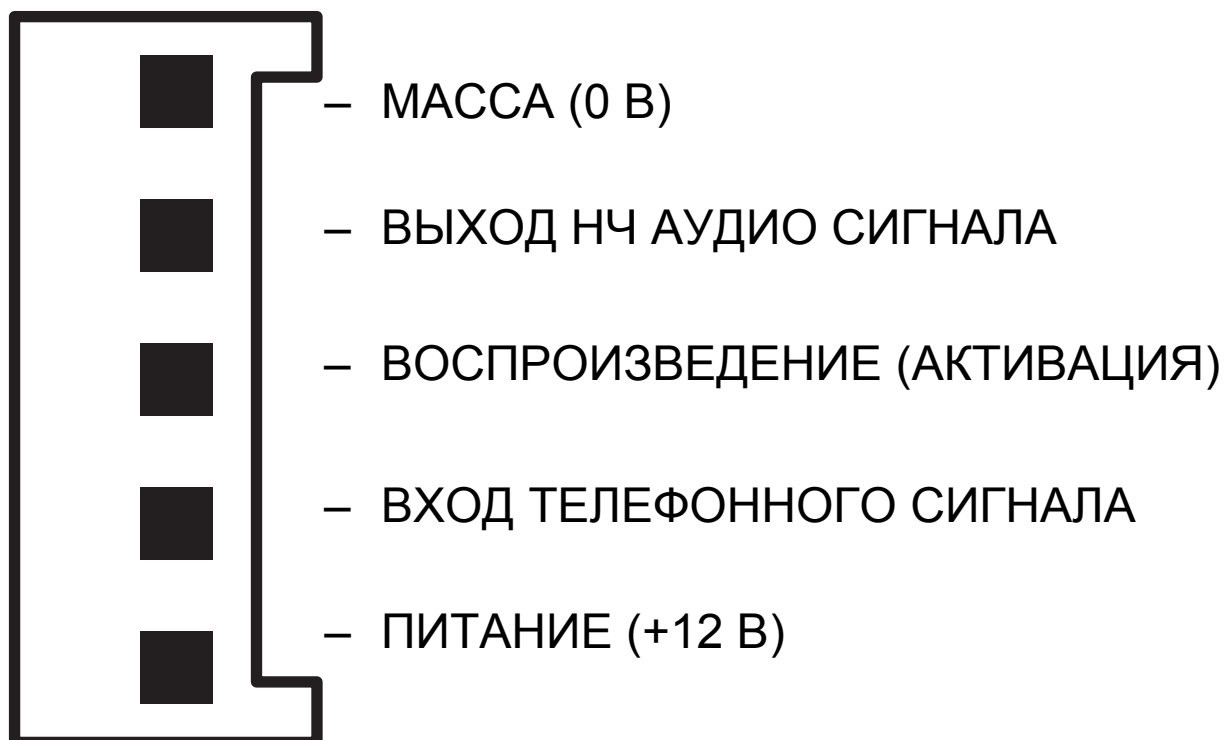
Рис. 1. Разводка контактов разъема модуля голосового оповещения SM-2.
