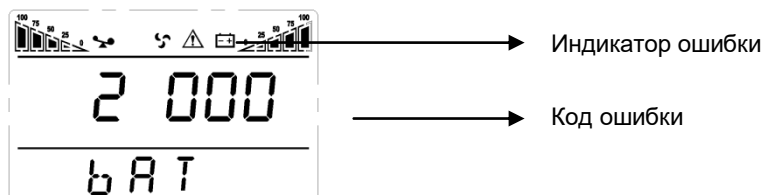
Рисунок 10 – Отображение кода ошибки на экране ИБП
