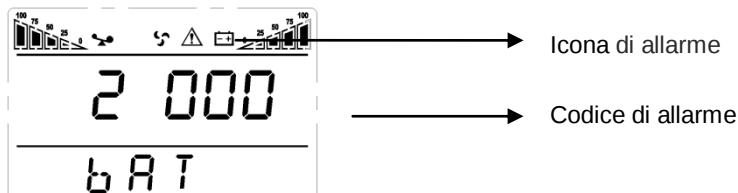
Figura 10 - Codice di errore sullo schermo dell'UPS
