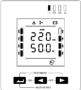
Рис. 9. Экран с кнопками управления ИБП
