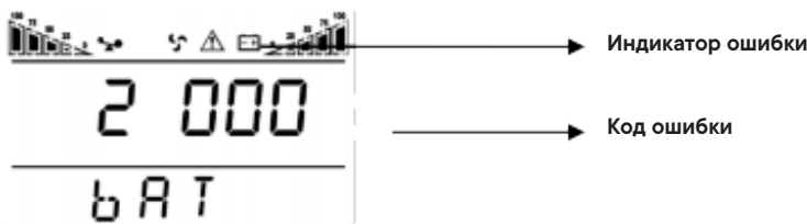
Рис. 10. Отображение кода ошибки на экране ИБП
