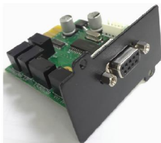
Рисунок 6 – Внешний вид платы AS400
