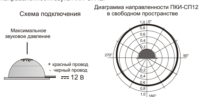
Рис.2 Схема подключения и диаграмма направленности звука оповещателя ПКИ-СП12.
