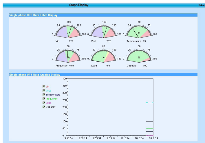
Рис. 3.6. Графическое отображение однофазного ИБП
