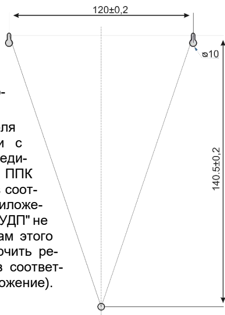
Рисунок 9 Разметка расположения отверстий крепления прибора (блока расширения)
