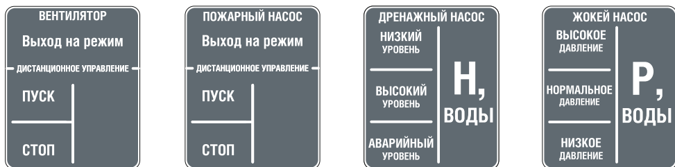
Рисунок 5 – Сменная этикетка панели управления ШУ
