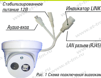
Рис. 1 Схема подключения видеокамеры
